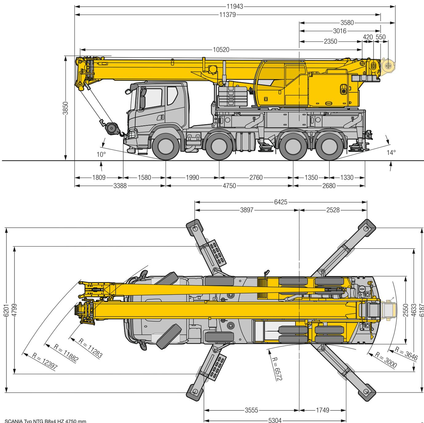
SCANIA Typ NTG B8x4 HZ 4750 mm
